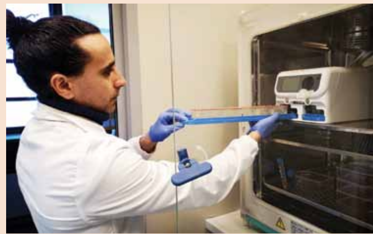
Lo strumento Zoë-CM2 consente di impostare flusso e forza meccanica da utilizzare durante la coltura dei chips. La possibilità di alimentare contemporaneamente fino a 12 chips permette di testare diverse condizioni nello stesso esperimento
